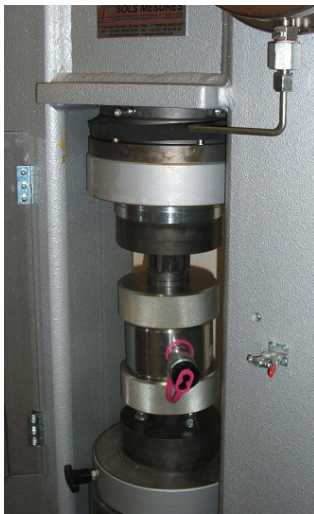
Equipement triaxial utilisé pour l'étude des caractéristiques géophysiques des roches (Source : http://lmv.univ-bpclermont.fr/mecanique-des-roches/ ).
